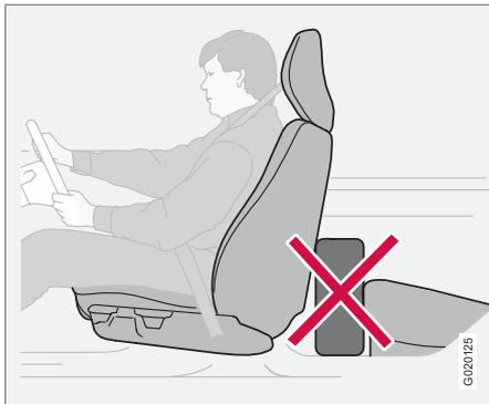
Não coloque qualquer objecto no piso atrás do banco do condutor/passageiro que possa evitar o funcionamento do sistema WHIPS.
