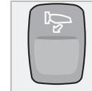
Utiliza-se para rebater os retrovisores exteriores para dentro, a partir da posição aberta, ou para fora, a partir da posição fechada.
