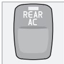
Pressione o botão para activar o ar condicionado na parte de trás do habitáculo. O ar condicionado na parte traseira do habitáculo é desactivado quando a ignição é desligada.
