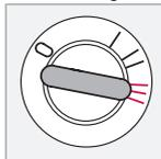
O motor de arranque é activado. O comando à distância é solto quando o motor arranca e regressa automaticamente à posição de condução.
