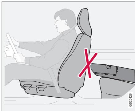
Não coloque qualquer objecto no banco traseiro que possa evitar o funcionamento do sistema WHIPS.
